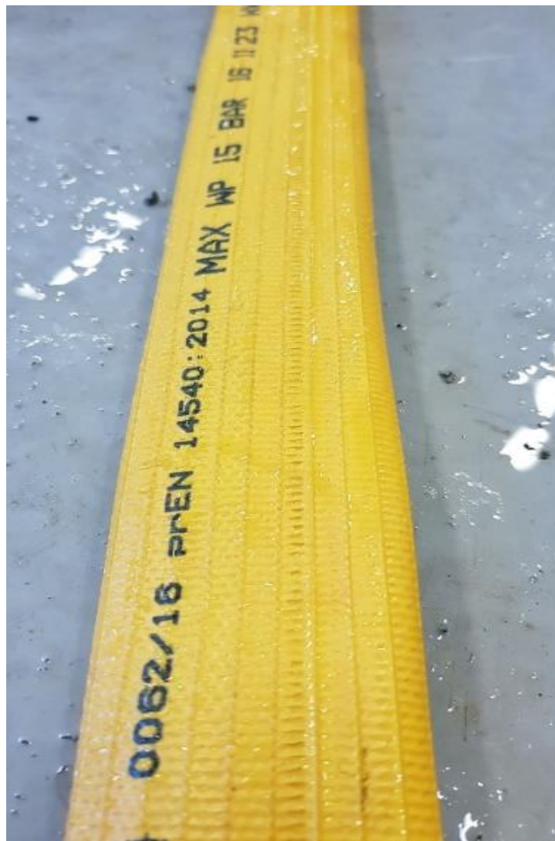
Bild 6. Brandslang från bild 5 efter blötläggning och tvätt.
