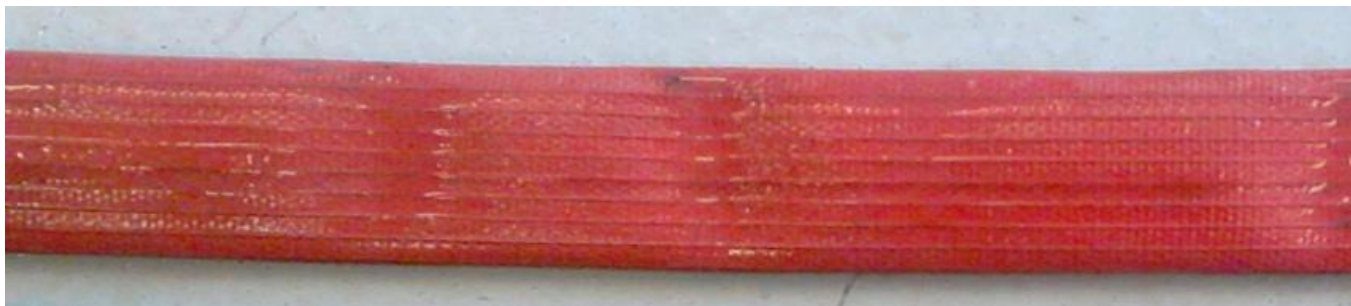
Bild 8. Brandslang med gummerad utsida från bild 7 efter blötläggning i 4 timmar i vatten vid 40° C med 1 % Lejon Kemi slangtvättmedel och därefter tvättad i slangtvättmaskin med borstar och vattenspolning.
