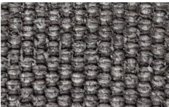
Bild 3. Använd kraftigt nedsotad (kontaminerad) brandslang
