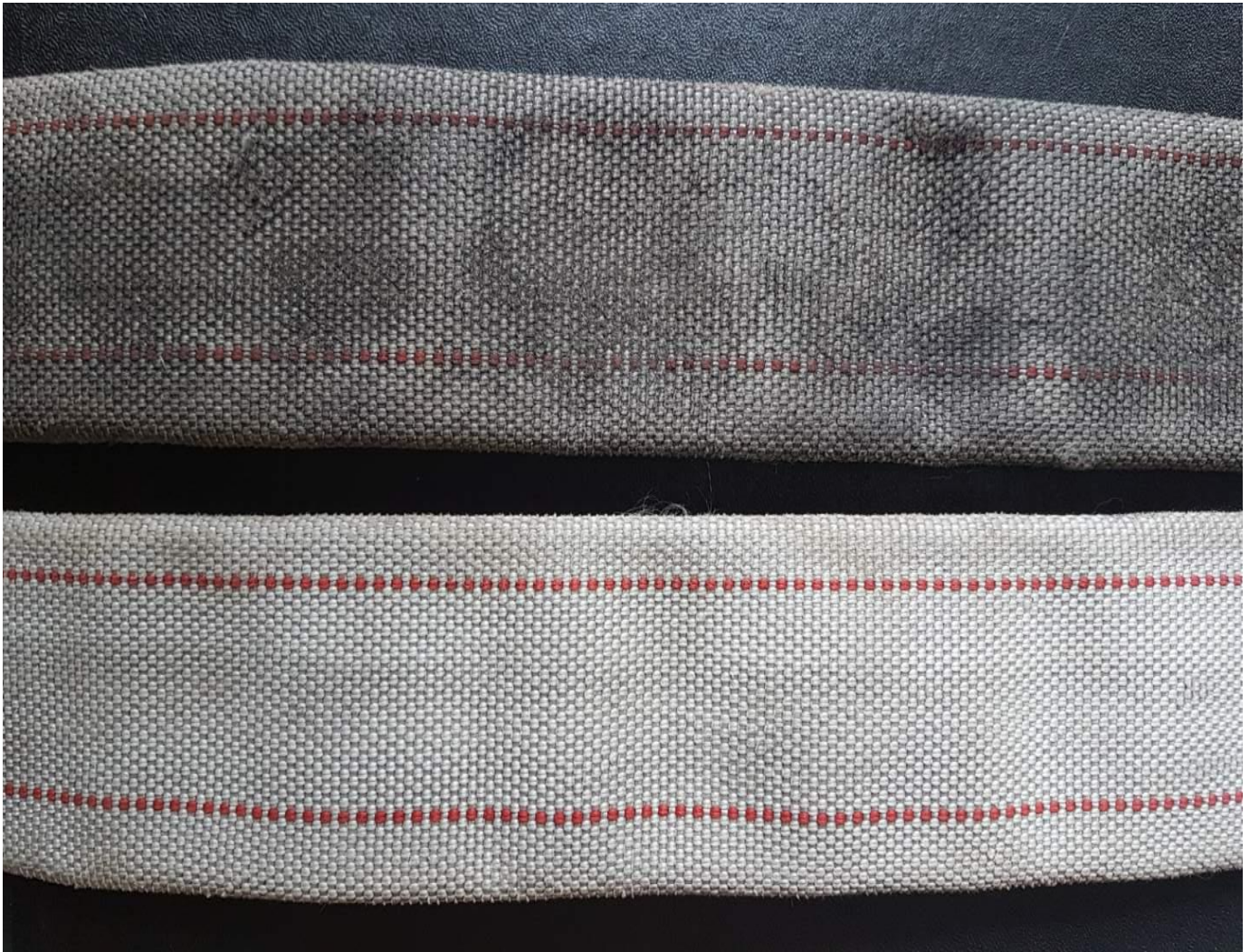
Bild 2. Överst kontaminerad brandslang, nederst brandslang blötlagd vid 60° C med 3 % Lejon Kemi Slangtvättmedel i 15 timmar samt tvättad i slangtvättmaskin med borstar och högtrycksspolning vid 160 bar.
