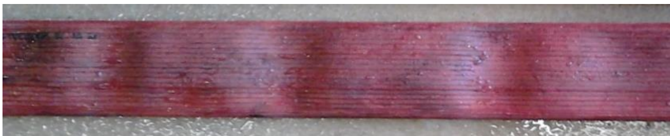
Bild 9. Kontaminerad brandslang med gummerad utsida efter blötläggning i kallt vatten (10-15° C) i 24 timmar utan tillsatt rengöringsmedel och därefter tvättad i slangtvättmaskin med borstar och vattenspolning.
