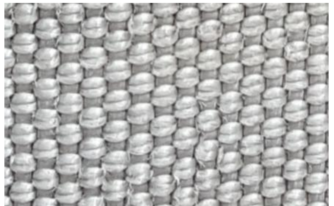
Bild 4. Brandslang från bild 3 efter blötläggning och tvätt
