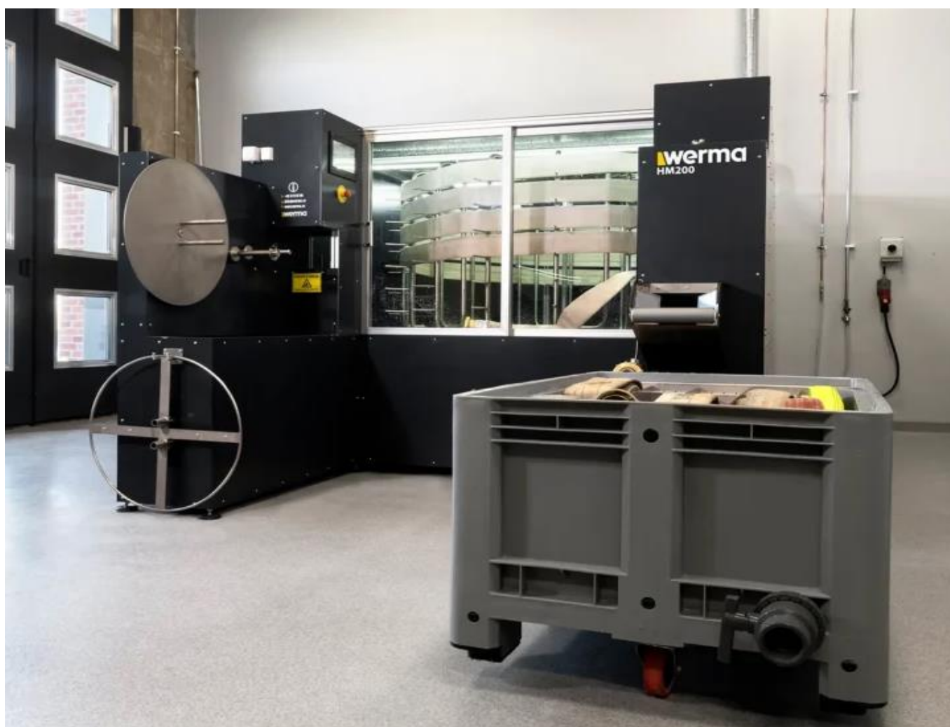
Bild 1. Blötläggningskar för brandslangar och slangtvättmaskin för tvätt av brandslangar, provtryckning, torkning samt upprullning.
